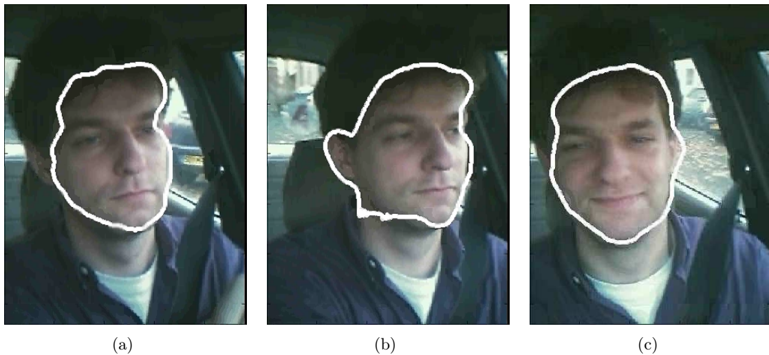
FIG. 2.14 – Exemple de suivi de visage du conducteur basé sur les contours actifs. Le modèle est décrit dans (Dokládal et al., 2004)
