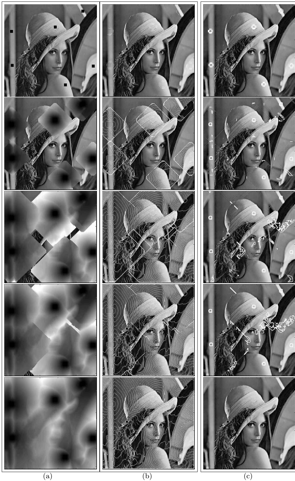
FIG. 4.3 – Propagation de la fonction distance. (a) Image initiale et la fonction distance pondérée par des valeurs d'intensité de l'image. (b) Contours de la fonction distance. (c) Points actifs dans l'itération en cours.
