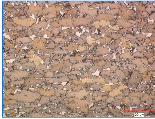
FIG. 2.30 – Micrographie de l'acier ferrito-martensitique D1957
