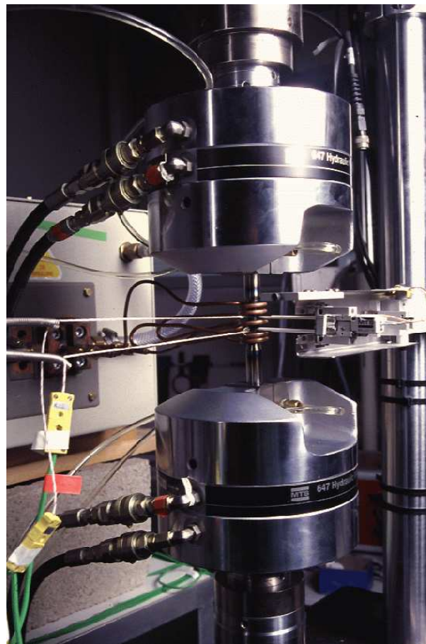
FIG. 1.8 – Spire d'induction, extensomètre et thermocouples
