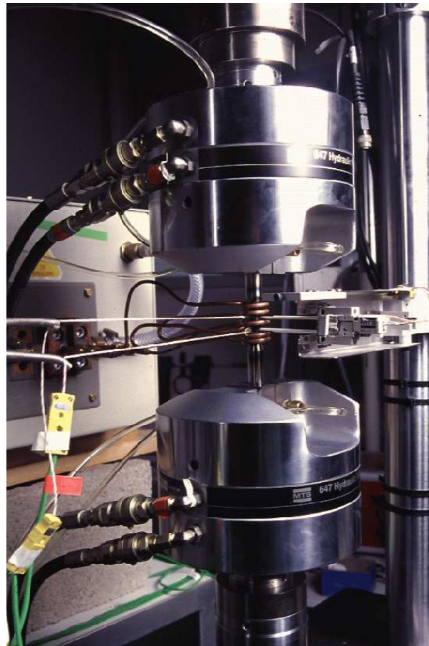
FIG. 1.8 – Spire d'induction, extensomètre et thermocouples
