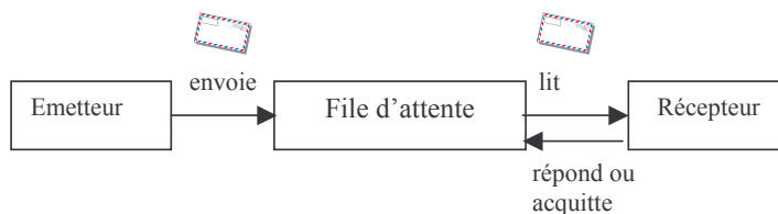
FIG. 3.2 – Le mode point à point de JMS
