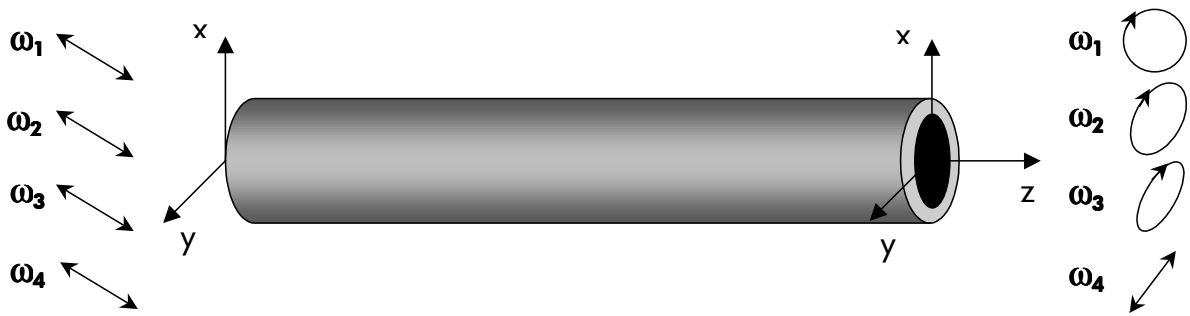
figure 1.3 : interprétation fréquentielle de la PMD dans le régime courte distance : lorsque la fréquence du signal d'entrée, polarisé ici à +45° des axes propres, varie, la polarisation de sortie évolue de façon périodique avec la fréquence
