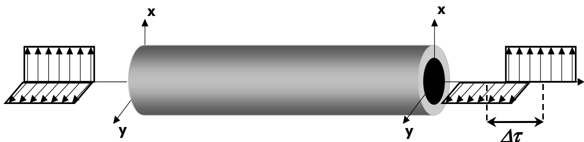
figure 1.4 : PMD du premier ordre dans le régime courte distance : élargissement d'une impulsion au cours de la propagation dans une fibre biréfringente
