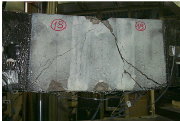
Figure III-16 Rupture d'une poutre renforcée en mode c
