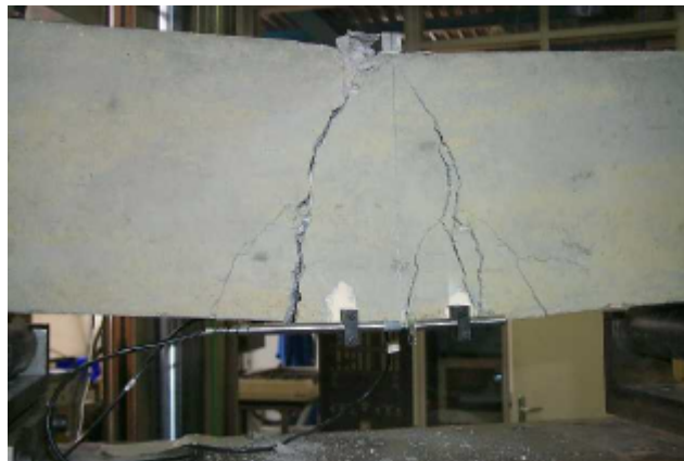
Figure III-6 Mode typique de rupture d'une poutre témoin
