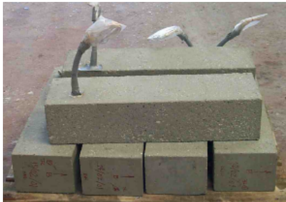
Figure II-3 Poutres sablées et équipées de tubes de protection des fils de jauges intérieures
