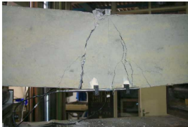
Figure III-6 Mode typique de rupture d'une poutre témoin
