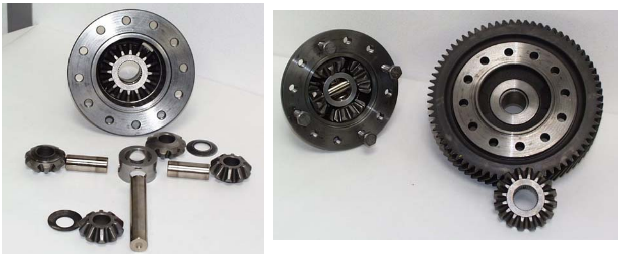
Figure II.1-5 : Exemple de différentiel avec quatre satellites
