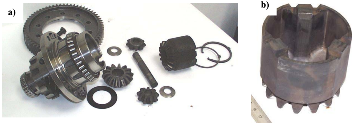
Figure II.1-6 : Exemple d'intégration de fonctions dans un même produit forgé : a) vue d'ensemble du différentiel ; b) détail du planétaire solidaire de la tulipe obtenu par extrusion
