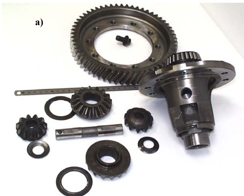
Figure II.1-4 : Exemple de guidage de planétaires avec appui plan : a) vue d'ensemble du différentiel ; b) détail d'un planétaire montrant la surface plane d'appui et le cylindre court assurant le centrage sur le boîtier
