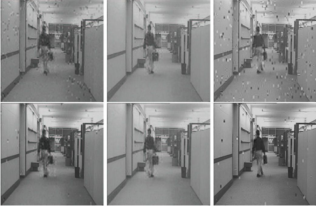
FIG. 3 – Trames reconstruites de la séquence "hall-monitor" à 566 Kbs. Première ligne : canal gaussien avec SNR=4.33 dB. Deuxième ligne : canal gaussien avec SNR=6.75 dB. Première colonne : schéma de codage JSC. Deuxième colonne : schéma de codage JSC+RM. Troisième colonne : schéma de codage MCA.
