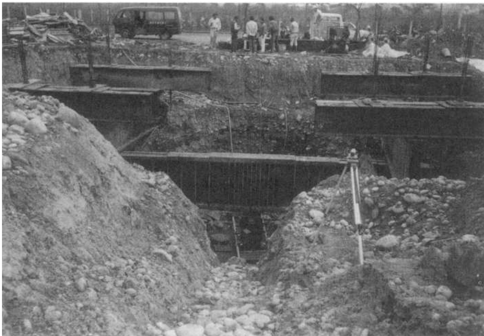
FIG. 1.16 – Vue d'un dispositif d'essai à la plaque de grandes dimensions (Lin et al., 2000)
