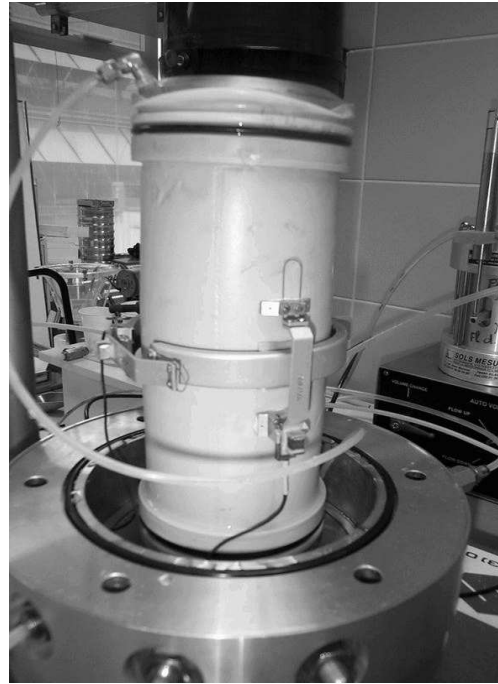
FIG. 2.4 – Dispositif de mesure locale de déformation axiale de l'éprouvette : (a) schéma du dispositif (Dufour-Laridan, 2001) ; (b) vue du dispositif
