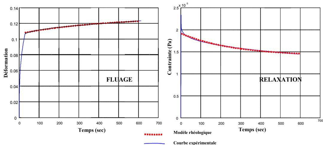
Figure 23 Superposition du modèle rhéologique aux courbes expérimentales
