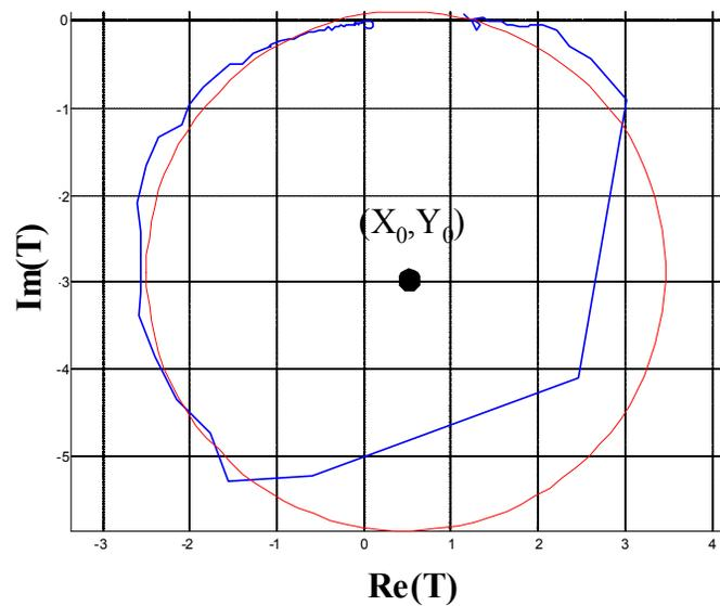
Ensuite, le tracé du module de la transmissibilité en fonction de la fréquence fournit la fréquence de résonance  $w_0$ , correspondant au maximum du module. La Figure suivante illustre la détermination graphique de  $w_0$  :
