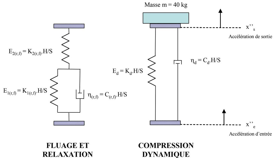
Figure 29 Modèles rhéologiques en fluage, relaxation et compression dynamique
