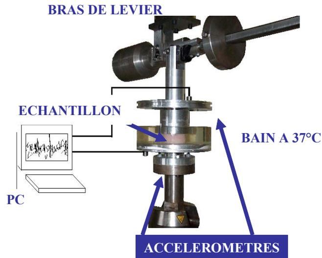
Figure 13 Montage expérimental pour la compression dynamique [44]
