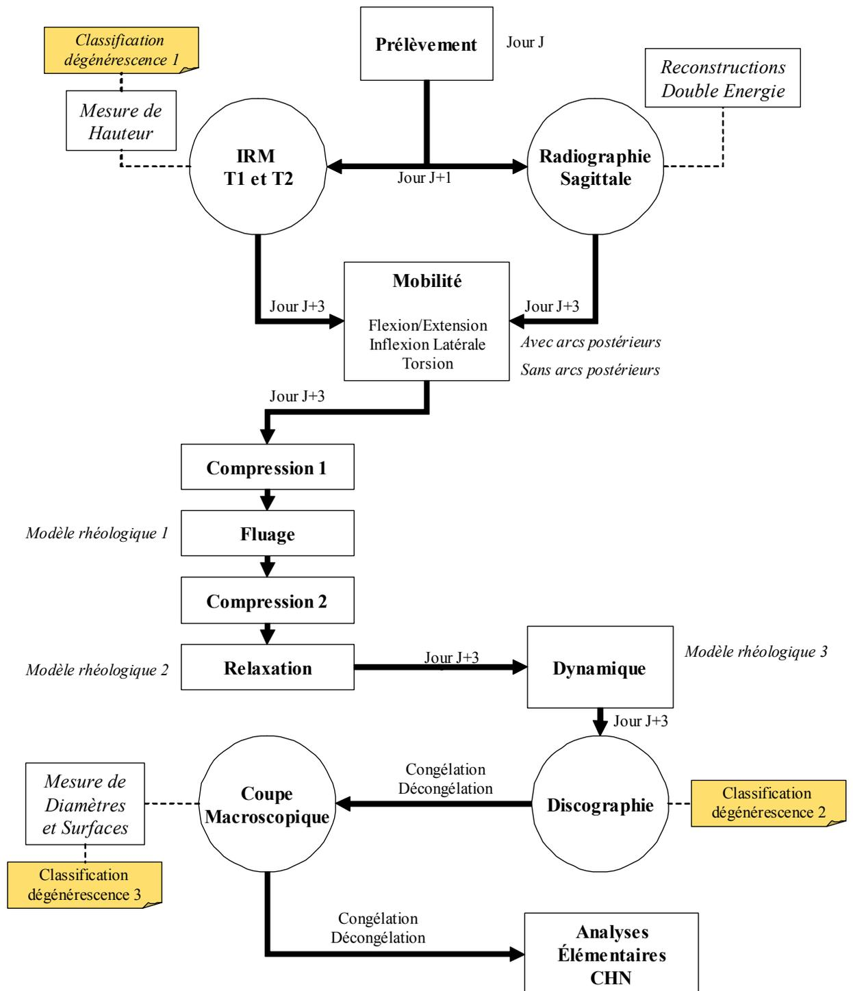
Figure 7 Schématisation du protocole expérimental
