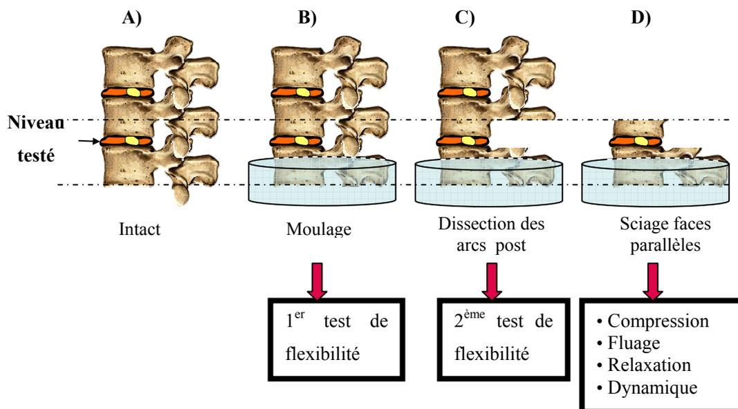
Figure 28 Préparation des spécimens pour l'expérimentation biomécanique globale
