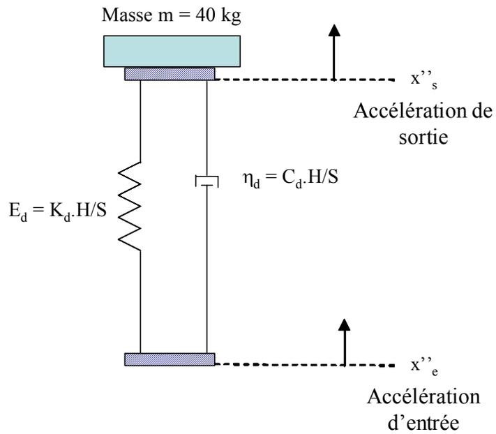
Les paramètres  $(K_d, C_d)$  sont déterminés à partir de la connaissance de la transmissibilité (T) :
