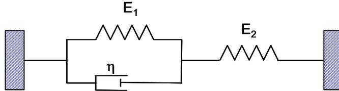
En fluage, les paramètres ( $E_{1f}$ ,  $E_{2f}$ ,  $\eta_f$ ) sont déterminés grâce à la méthode de Keller et al., dont les équations principales sont présentées ici. Ce calcul a été étendu, en utilisant les mêmes principes, à l'obtention des paramètres ( $E_{1r}$ ,  $E_{2r}$ ,  $\eta_r$ ) de relaxation.
