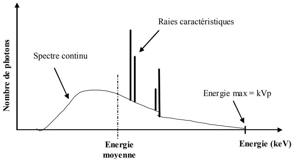
Figure 40 Spectre caractéristique d'un faisceau de rayons X
