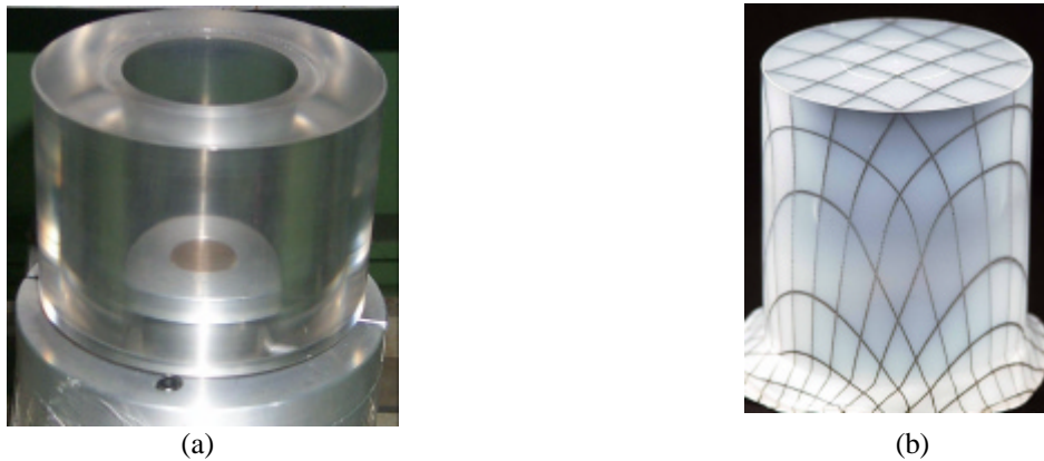
figure III-5 : Géométrie du moule transparent en polycarbonate ( D = 60 mm et h = 65 mm) (a) et pot final obtenu (b) avec une feuille sérigraphiée.
