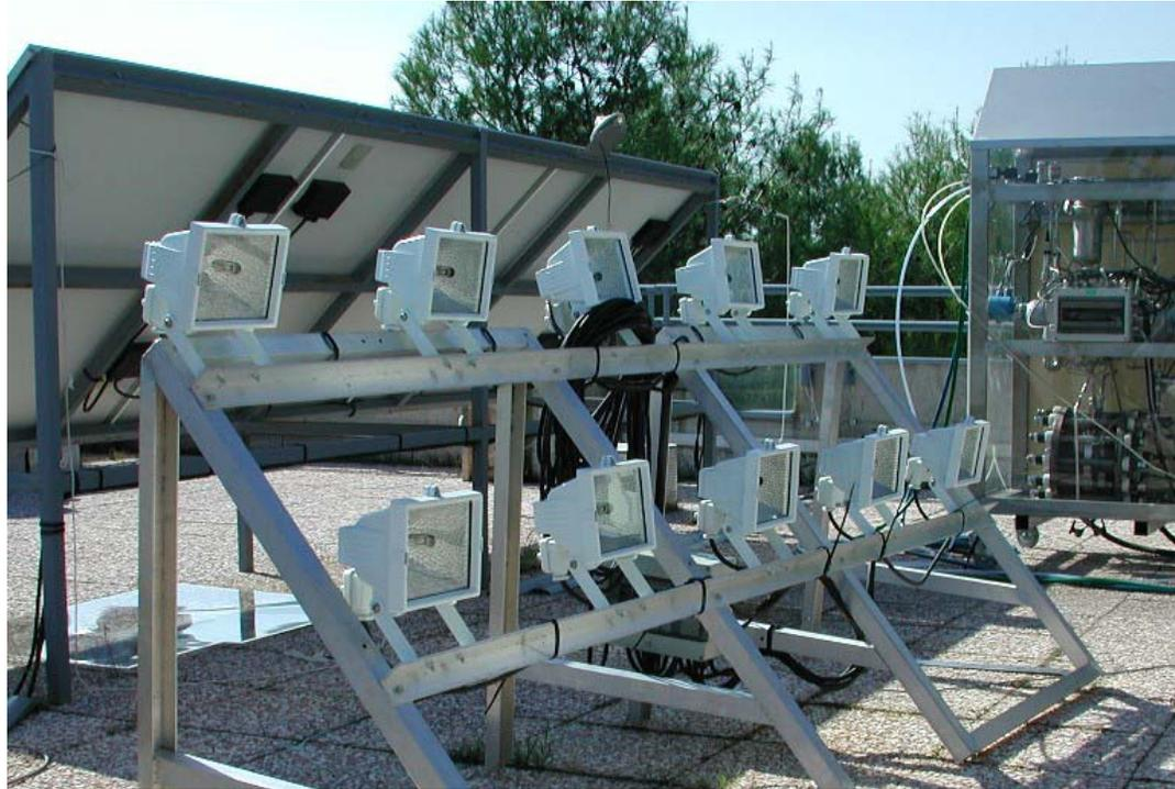
10 lampes de 500 W : puissance variable de 0 à 5 kW.
