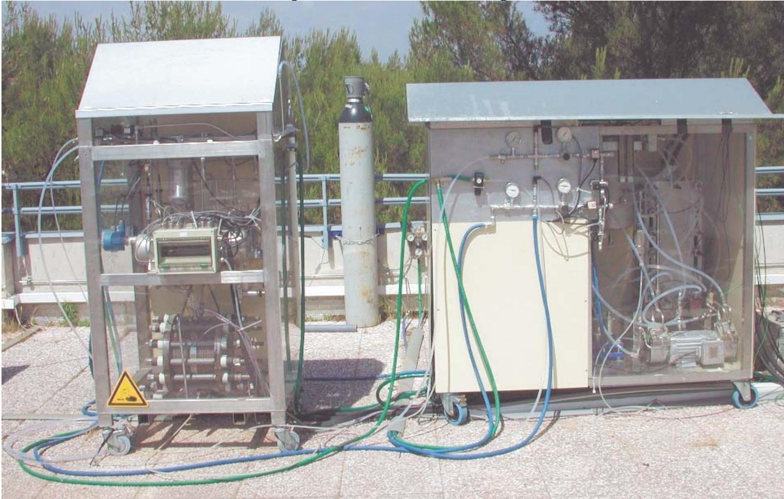
**Electrolyseur**: 16 cellules de 300 cm<sup>2</sup>, technologie alcaline zéro gap, Hydrogen Systems, périphérique conçu au laboratoire
