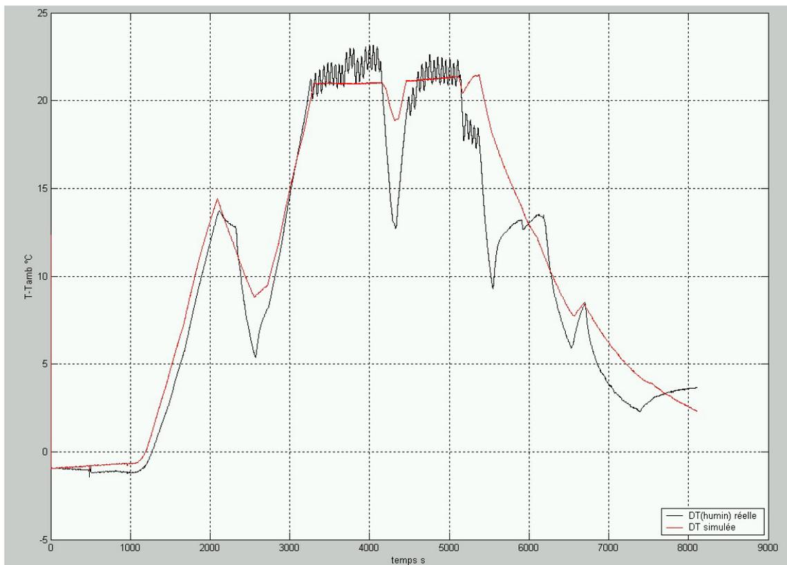
Figure IV-18 : Différence entre la température de la pile (sortie eau) et la température ambiante – Comparaison avec la simulation.
