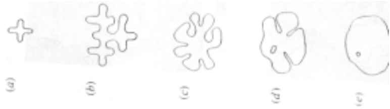
FIG. 2.2 – Evolution de la structure durant la solidification avec cisaillement[44]
