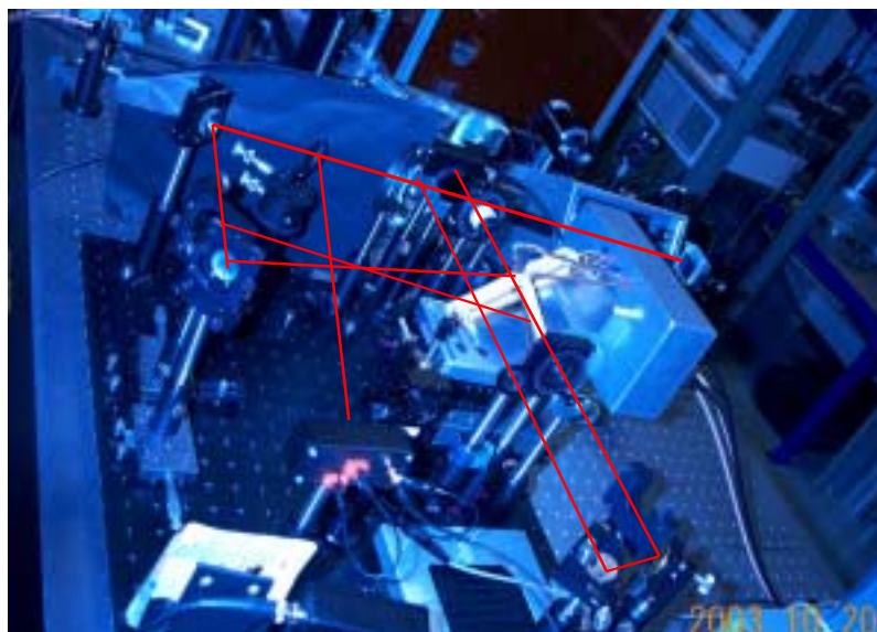
Figure 4.11: schéma du montage expérimental de mesure du temps de commutation optique.
