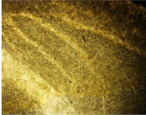
Figure V.3-9 : observation au microscope optique de la bande de cisaillement formée « échantillon S27-2 »
