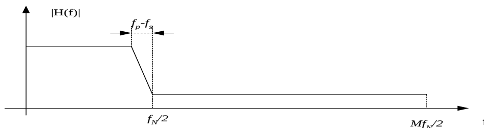
Figure 1.21 – Gabarit du filtre décimateur à la sortie du modulateur \Sigma\Delta .
