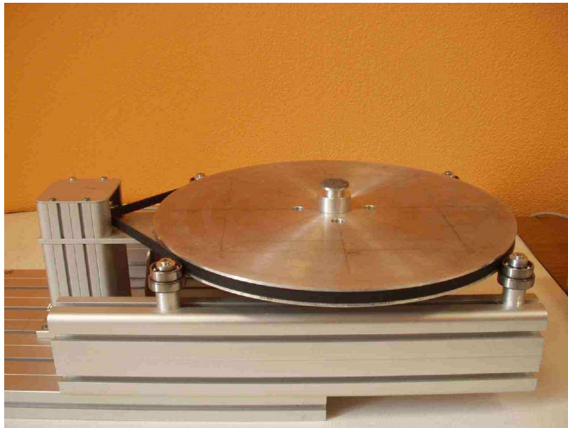
Figure 1. Photographie du plateau rotatif constituant le montage expérimental préliminaire.
