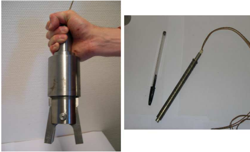
FIG. 5.9 – Photos de la pince automatique et de l'actionneur à effet mémoire
