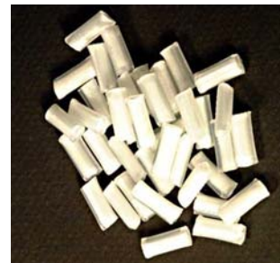
FIG. 1.1 – Granulé fibres longues de 12 mm, chargé à 30%
