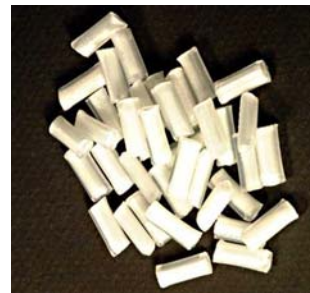
FIG. 1.1 – Granulé fibres longues de 12 mm, chargé à 30%
