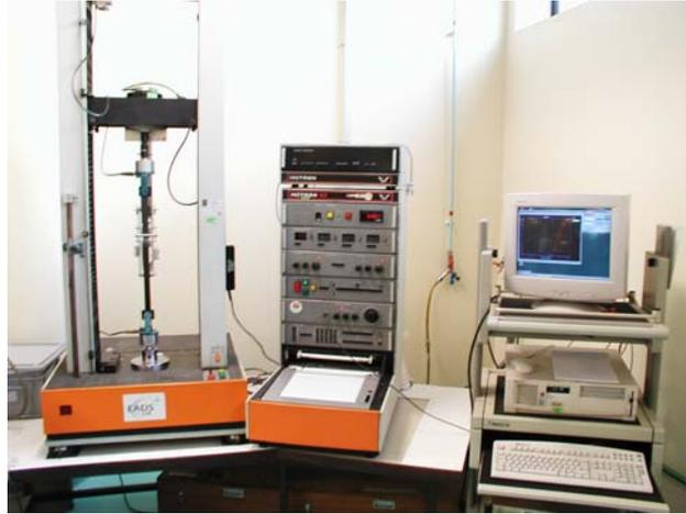
**Fig. 2.31 :** Machine de pelage et dispositif d'acquisition
