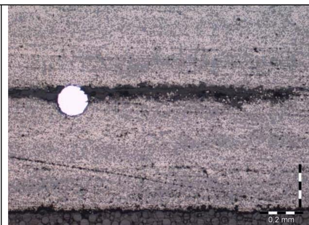
**Fig. 2.9** : Thermocouple entre deux plis
