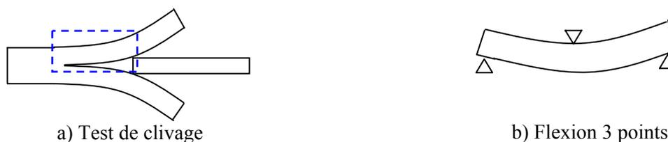
Fig. 2.27 : Essai de clivage et essai de flexion 3 points
