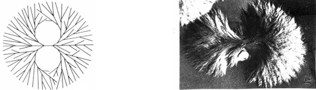
**Fig. 1.21.a** : Représentation schématique d'un sphérolite    **Fig. 1.21.b** : Vue d'un sphérolite de PA66
