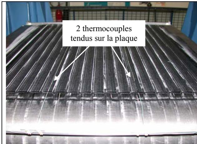
**Fig. 2.4** : Thermocouples tendus sur la plaque
