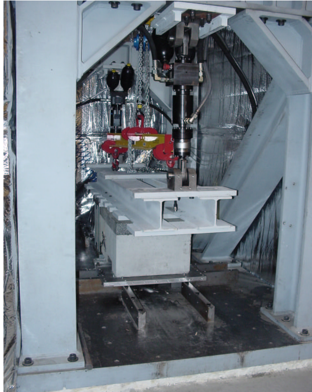
FIGURE 8.17. Bâti d'essai SIFIRE et éprouvette mise en place
