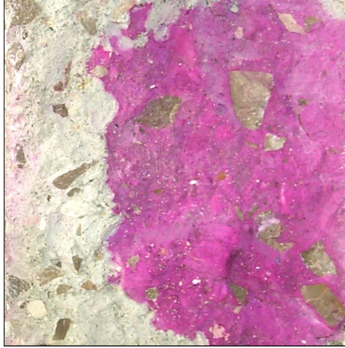
Fig. 3.15 – Front de carbonatation détecté par projection de phénolphthaléine sur une éprouvette de béton M25 après 14 jours de carbonatation accélérée.
