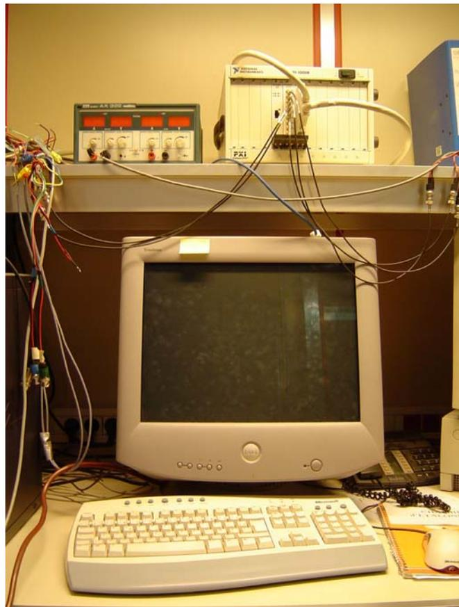
Figure II-24 Châssis PXI et ordinateur d'acquisition
