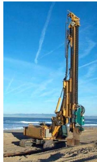
Figure I-4 (a) Schéma d'un vibreur avec système de guidage (modèle TM 13-16 de ABI) ; (b) ABI Mobilram système en cours de travail
