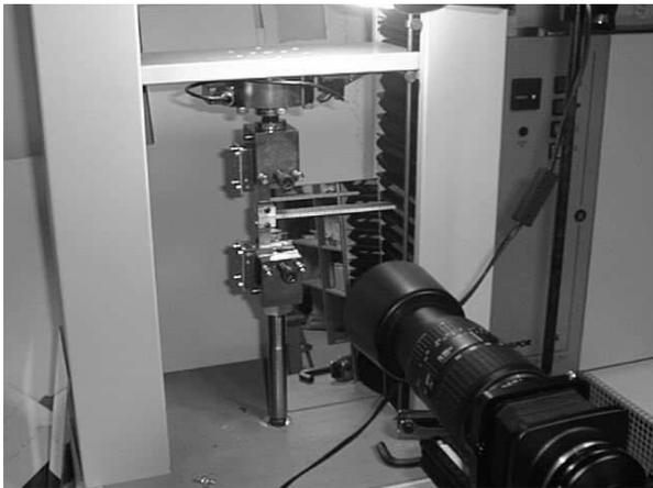
Figure 3.23: Dispositif expérimental DCB en quasi-statique.
