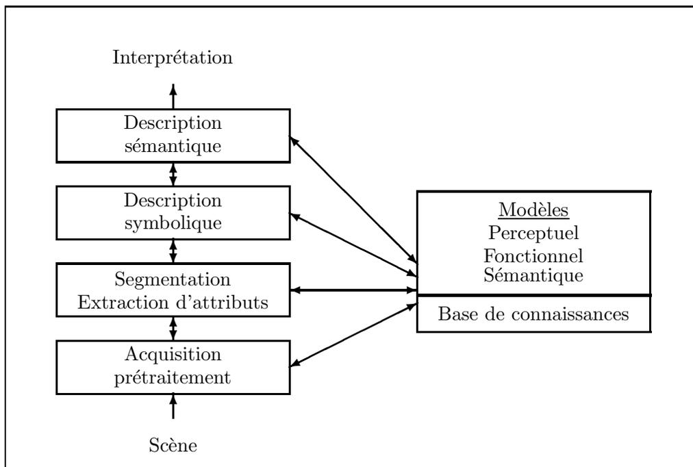
**Figure 8.1 :** Principe d'un système de vision par ordinateur.
