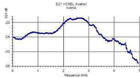
FIG. 3.15 – Caractéristique fréquentielle du VCSEL : Thales.
