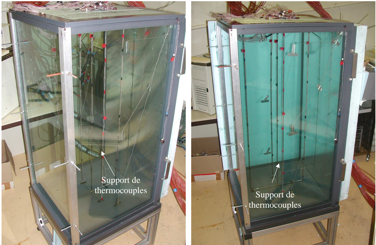
Figure A-14 : Dispositif expérimental pour la mesure de la température d'air dans la maquette vide
