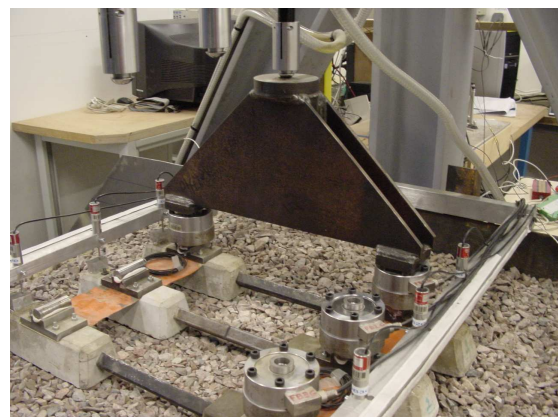
FIGURE 3.33. Mise en place des triangles en acier et des capteurs de forces sur les blochets
