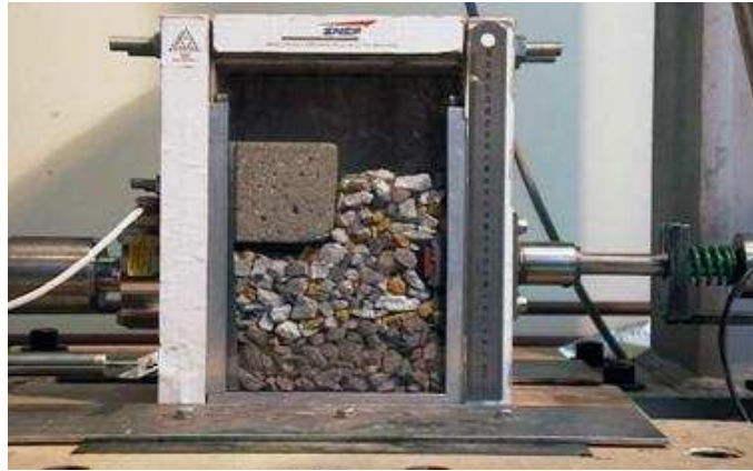
FIGURE 1.11. Expérience reproduisant le bourrage du ballast (BOUBA)
