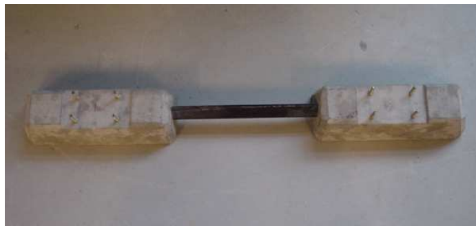
FIGURE 3.1. Traverse à échelle réduite (1/3)
