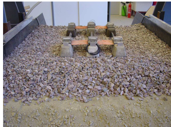
FIGURE 3.31. Mise en place des traverses par rapport aux positions des trois vérins hydrauliques
