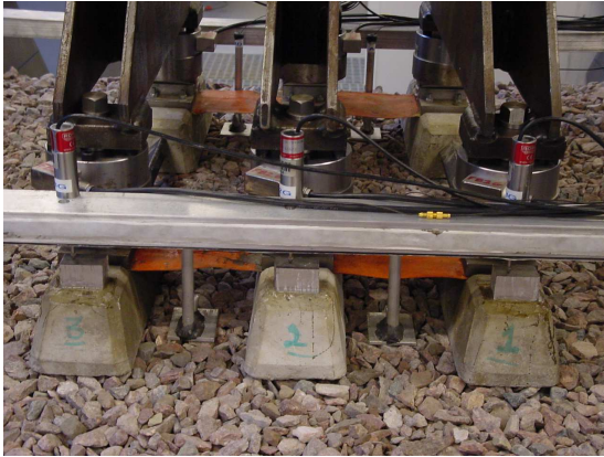
FIGURE 3.34. Mise en place des accéléromètres (protégés par des tiges en aluminium) pour mesurer les accélérations dans le ballast entre les traverses
