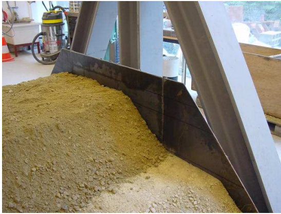
FIGURE 3.28. Mise en place de la troisième couche de GNT (0,2 m)
