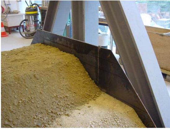
FIGURE 3.28. *Mise en place de la troisième couche de GNT (0,2 m)*
