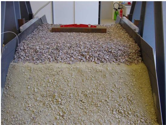
FIGURE 3.30. *Mise en place de la première couche du ballast compactée (0,1 m)*
