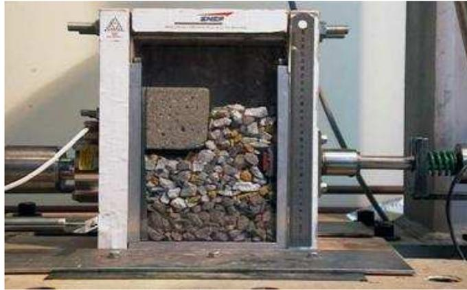
FIGURE 1.11. *Expérience reproduisant le bourrage du ballast (BOUBA)*
