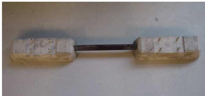
FIGURE 3.1. *Traverse à échelle réduite (1/3)*
