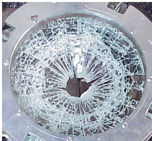
Fig. 42. Profil de fissuration du vitrage après la chute d'une bille de 4 kg en acier sur un vitrage 44.2, 300 mm par 300 mm, fixé en appui simple circulaire (275 mm de diamètre).
