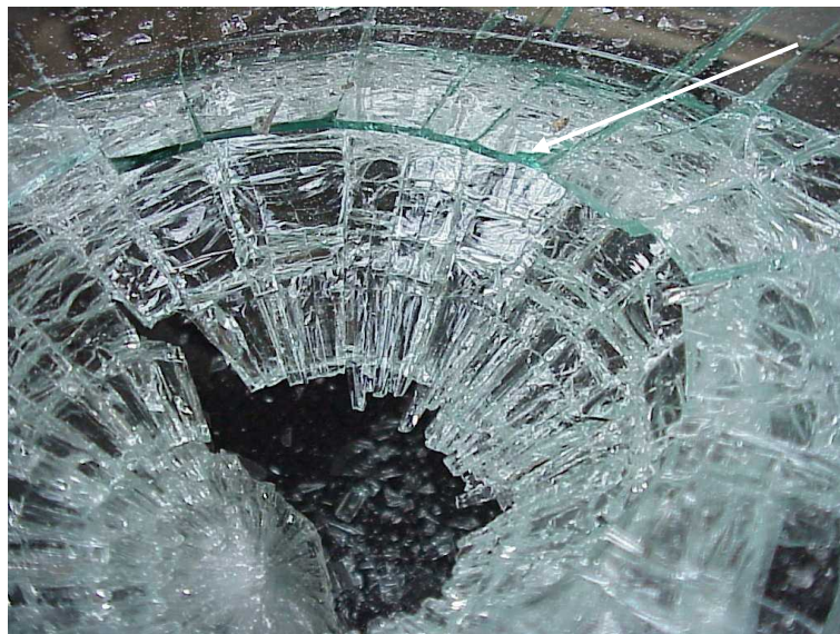
Fig. 35. Impact d'une bille en acier de 4 kg chutant de 3 m sur un vitrage feuilleté 44.2, 1100 mm par 900 mm (Essai normatif EN 356 classe P2A). Le pli de verre supérieur (impacté) est fissuré dans le plan du vitrage pratiquement à la moitié de son épaisseur (indiqué par une flèche).
