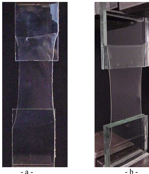
Fig. 56. Profil des délaminages à l'interface verre/PVB lors d'un essai de traction sur éprouvettes de verre feuilleté pré-fissurées 44.2. a) suite à un mauvais alignement de l'éprouvette b) dans des conditions idéales de sollicitation.
