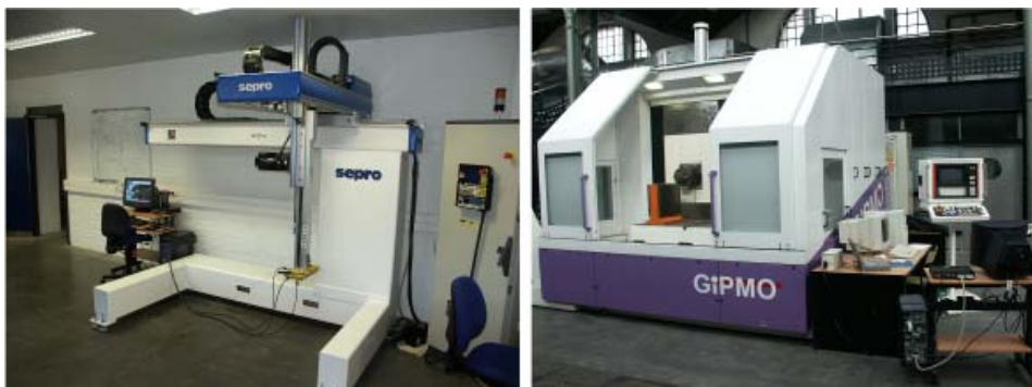
Figure A3.2 - Aperçu des démonstrateurs : Robot cartésien 3 axes (gauche) ; Prototype de machine-outil à dynamique élevée (droite).
