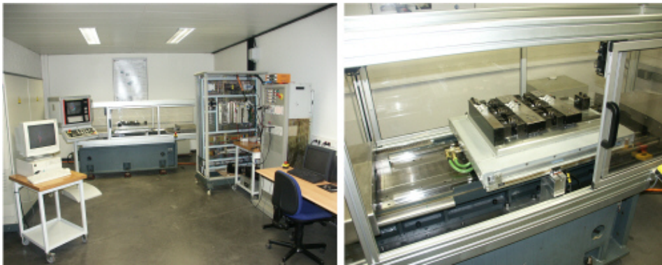
Figure A3.1 - Banc d'essai monoaxe. (Caractéristiques : système 3 masses 2 ressorts embarquées 260+20,6+16,5kg).
