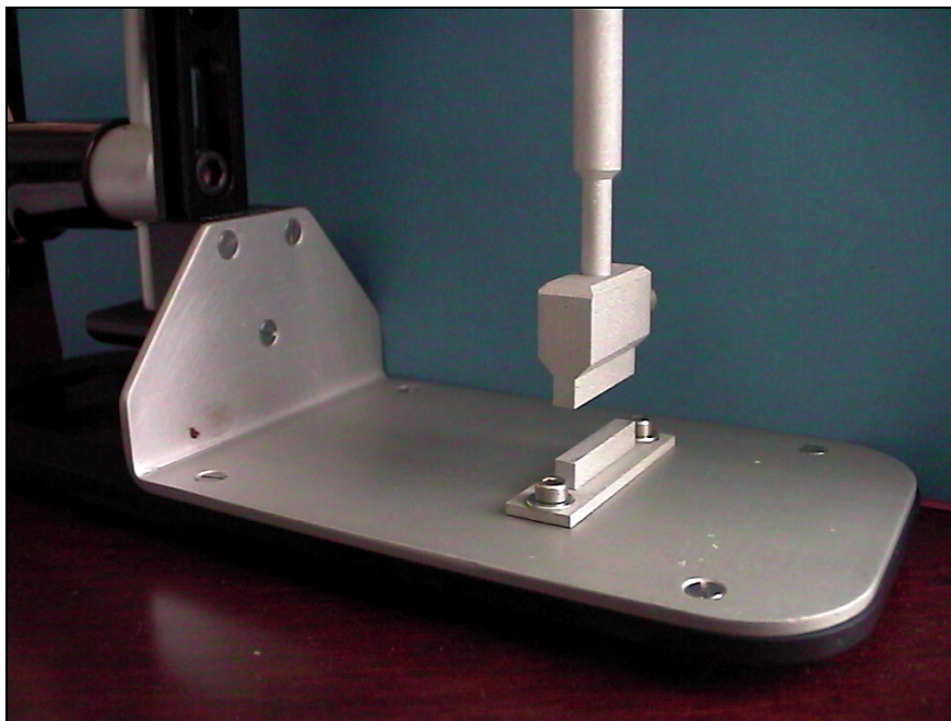
Figure 75 : Zoom sur les poinçons de la machine portable de bipoinçonnement
