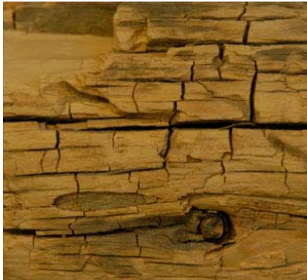
Figure 7. La pourriture molle, (ressemblance avec la pourriture brune).
