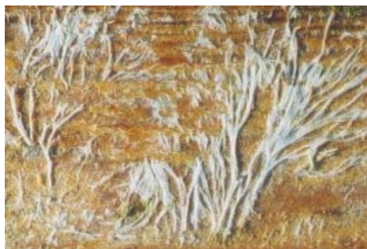
Figure 5. Mycélium de la pourriture blanche sur du bois de sciage
