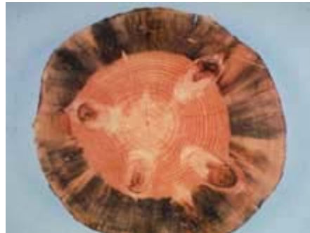
Figure 2. Bleuissement dans l'aubier
