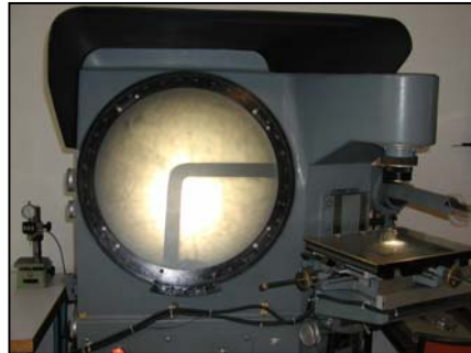
Figure 4.17: Projecteur du profil pour mesure du retour élastique. Modèle P500_67N°524
