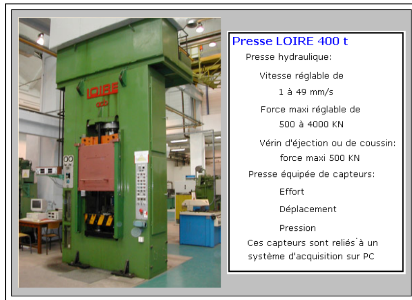
Figure 4.3: Photo de la presse utilisée (LOIRE 4000 KN)
