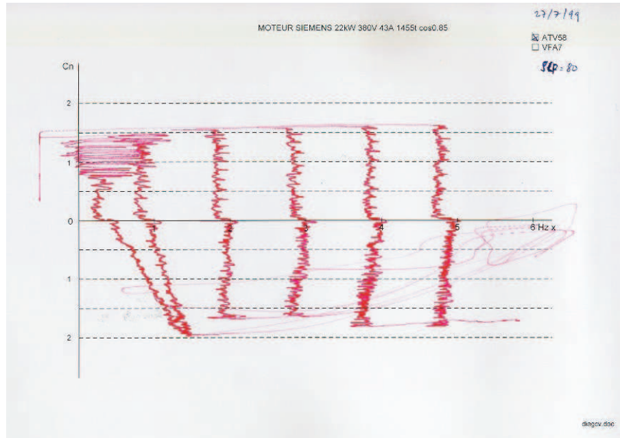
Figure 9 – Performances statiques à basse vitesse, quadrants moteur et générateur. Les courbes sont obtenues en se plaçant à vide (sans charge) à la vitesse souhaitée (ici, 0.5 Hz, 1 Hz, 2 Hz, 3 Hz, 4 Hz et 5 Hz). Ensuite, nous augmentons le couple de charge jusqu'à atteindre la limitation de courant. Le couple maximum obtenu dépend du niveau de courant maximum accepté.
