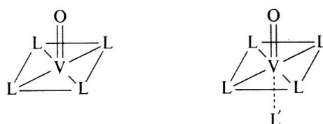
Figure V.3 : structure pyramidale et bipyramidale à base carrée de l'ion vanadyle.
