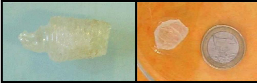
**Figure I. 3-52 : cristaux de  $\text{Lu}_2(\text{WO}_4)_3$  obtenus par la méthode Czochralski**
