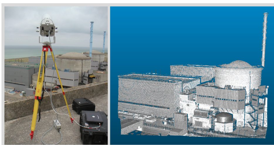
FIG. 1 – Scanner laser terrestre (de marque Riegl , à gauche) et nuage de points 3D résultant (560 000 points, colorés en fonction de l'intensité du signal retour, à droite).
