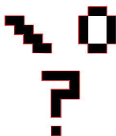
FIG. 3.12 – Composantes connexes en 8-connexité, détournées sur une image noir et blanc. En 4-connexité, les 4 barres de la forme "0" seraient des composantes connexes indépendantes. Le "point" du point d'interrogation est une composante connexe à lui tout seul, et ce quelle que soit la connexité.
