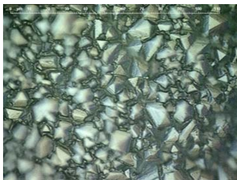
Photos prises au microscope Nomarski (×50) d'un satinage acide
