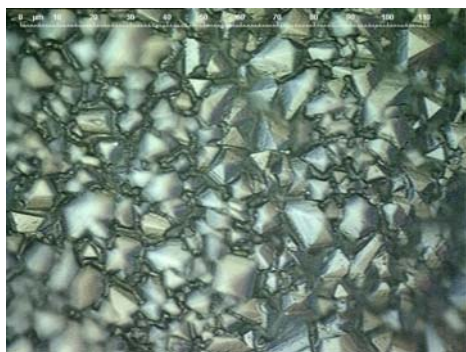
Photos prises au microscope Nomarski (×50) d'un satinage acide
