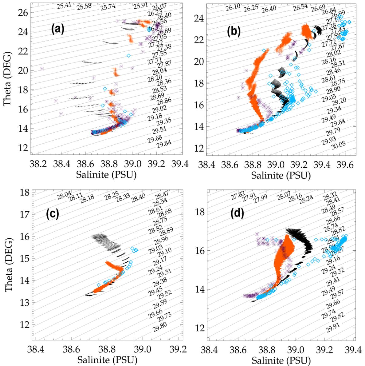
Fig.3.11 : Diagrammes  $\theta/\sigma$  de MED16-07 (rouge) moyennés sur les 14 dernières années, de POEM (diamant : après 1987 et étoile : avant 1987), et MEDATLAS-II (noir) dans l'Ouest de l'arc de Crète (colonne à gauche) et au Sud du BL (colonne à droite), pendant (a) le mois de septembre, (b) le mois de novembre et (c et d) le mois de mars.
