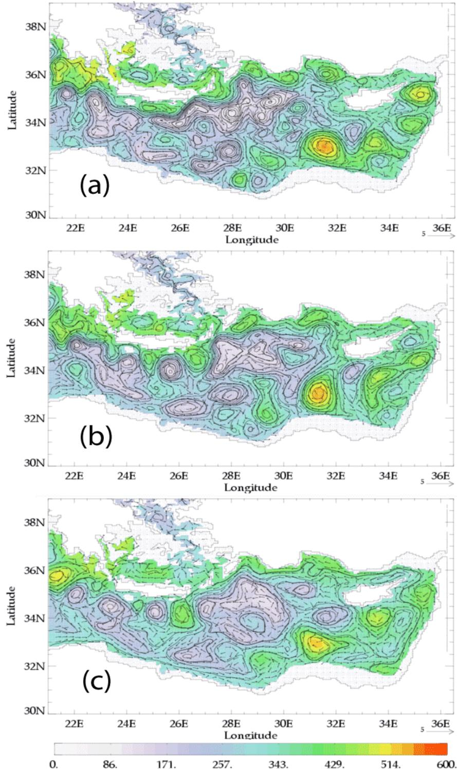
Fig.5.19: Série temporelle des isolignes de la fonction de Bernoulli et isocouleurs de la profondeur et de la vitesse projetées sur la surface de l'isopycne 29.10 dans le Bassin Levantin de la 17<sup>ème</sup> année en (a) juin, (b) septembre et (c) en décembre. Les couleurs indiquent la profondeur en mètres.
