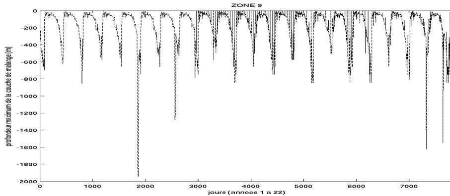
Fig.3.18 : Maximum de la profondeur de la couche de mélange en mètre dans la mer Egée (Zone 9 sur la Fig.2.6) de l'année 2 à l'année 23 de la simulation MED16-07.
