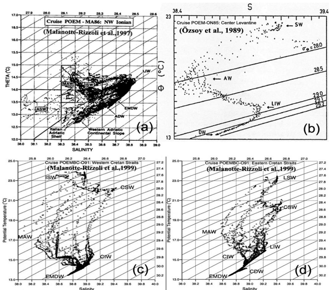
Fig.1.6 : Diagrammes  $\theta/S$  de plusieurs régions de la Méditerranée Est: (a) Au Nord-Ouest du Bassin Ionien d'après Malanotte-Rizzoli et al. (1997), (b) Dans le Bassin Levantin d'après Özsoy et al. (1989), (c) Dans les passages Ouest de l'arc de Crète et (d) Dans les passages Est de l'arc de Crète d'après Malanotte-Rizzoli et al. (1999).
