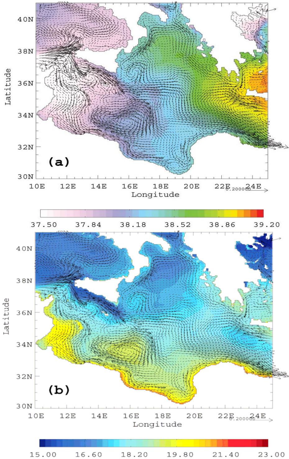
Fig 4.1 : Une moyenne des premiers 50 m de profondeur sur les 13 dernières années de l'expérience MED16-07, une flèche sur trois est tracée, l'échelle de la vitesse 1/20 cm s<sup>-1</sup> (a) vitesse sur la salinité, (b) vitesse sur la température.
