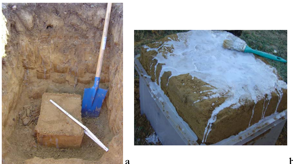
Figure II - 4. Prélèvement d'un bloc intact de limon in situ
