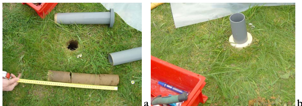
Figure II - 36. Test du dispositif de la mise en place in situ du tensiomètre
