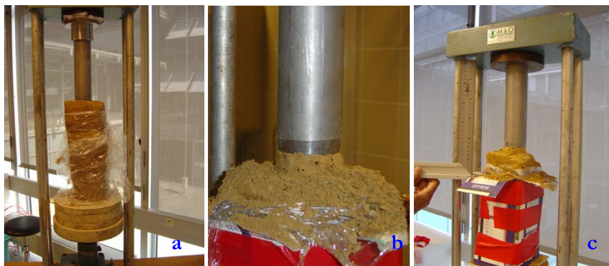
Figure II - 46. Carottage des échantillons de limon
