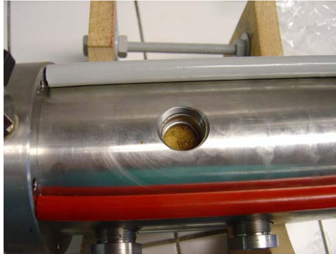
Figure II - 48. Préparation de la surface de contact échantillon – tensiomètre
