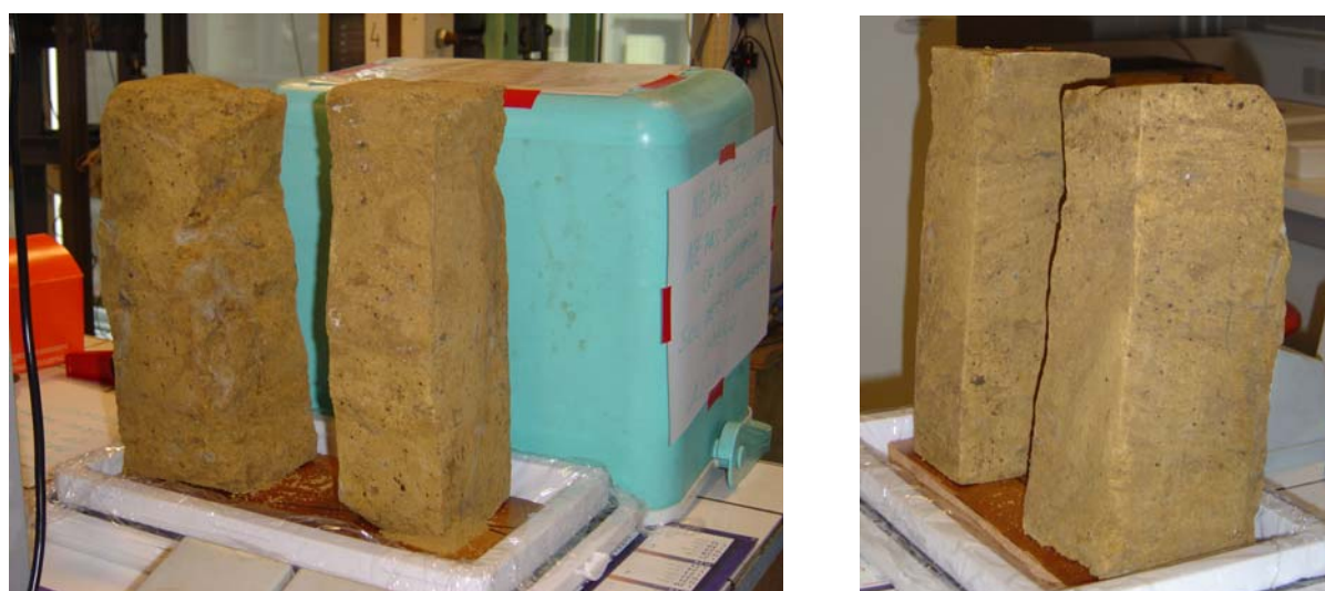
Figure II - 45. Séchage des blocs de limon
