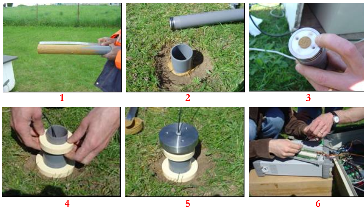
Figure II - 39. Mise en place in situ du dispositif de mesure
