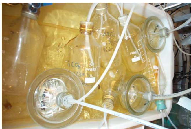
Figure II - 53. Dispositif d'imposition de la succion par phase vapeur
