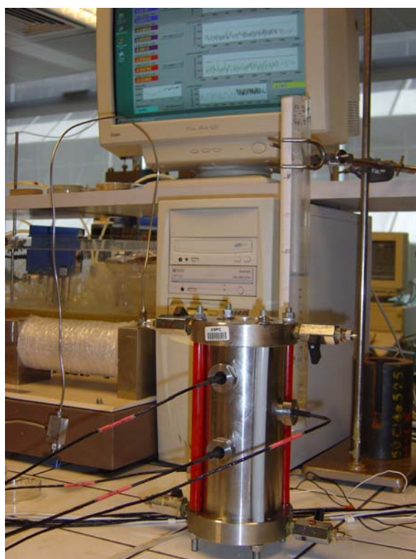
Figure III - 14. Essai de perméabilité avec la colonne d'infiltration
