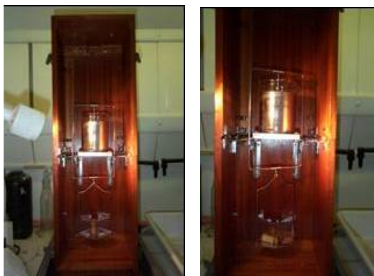
Figure II - 54. Dispositif de détermination du volume d'échantillon d'argile verte
