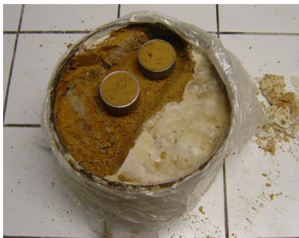
Figure II - 51. Carottage des petits échantillons de limon
