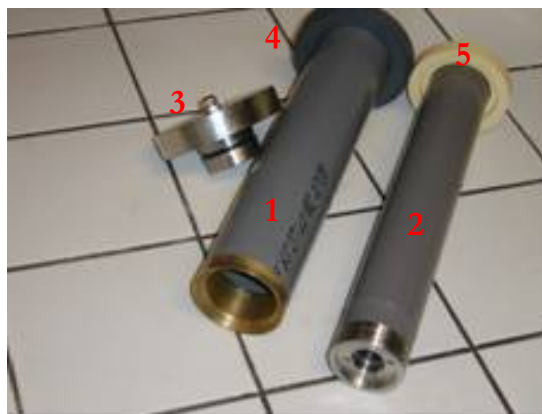
Figure II - 26. Dispositif type utilisé in situ pour la mise en place du tensiomètre
