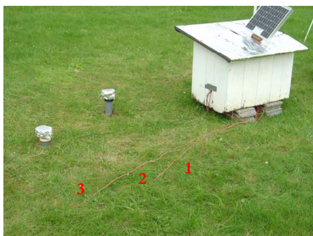
Figure II - 40. Placement des 3 sondes de température in situ
