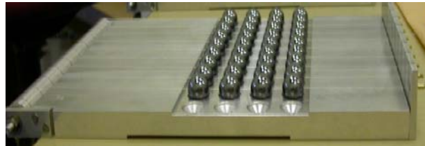
Figure C.I.11 : Plaque de collage dont l'espacement entre les axes des billes est de 24 mm. Le positionnement des billes est assuré par un trou usiné dans la plaque.
