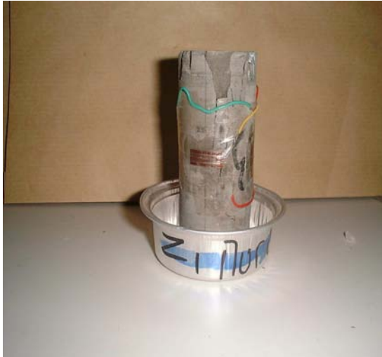
b) rupture pour l'essai (98% RH).
