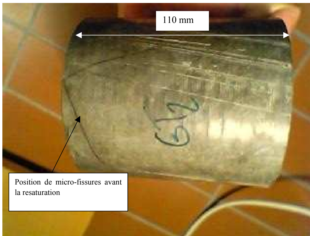
Figure 4-25a : Micro-fissures à la surface extérieure du tube épais GT2 avant la resaturation.
