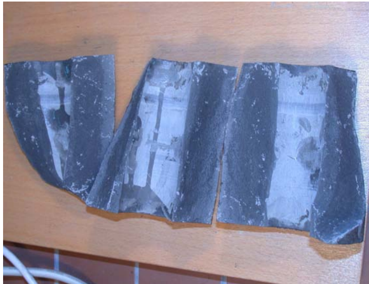
Figure 4-25d : Rupture du tube épais GT2.
