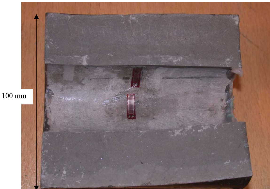
Figure 4-21d : Coupe transversale du tube GT1 (plan de rupture).
