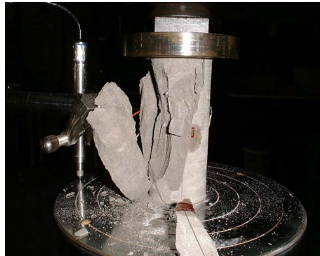
c) rupture pour l'essai (44% RH).
