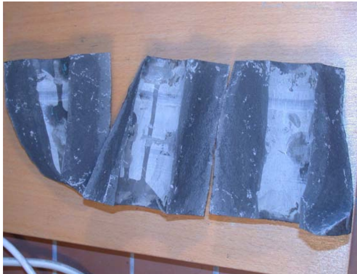
Figure 4-25d : Rupture du tube épais GT2.
