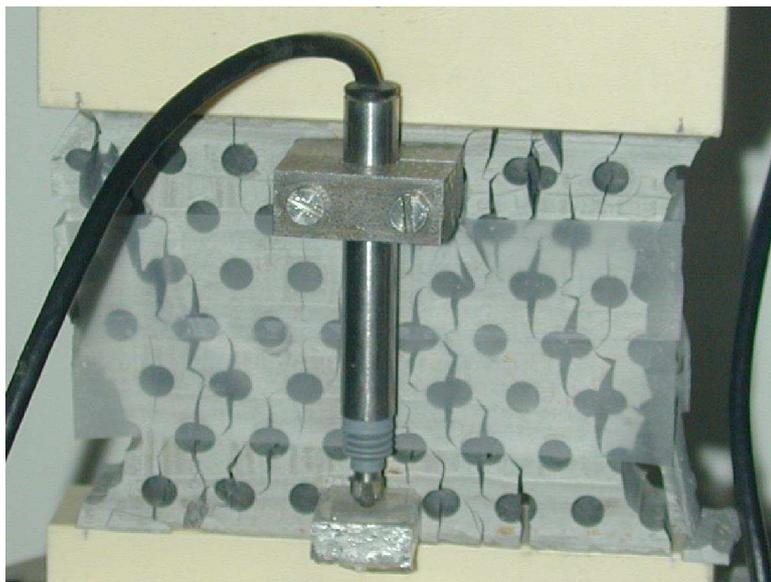
FIG. 2.8: Faciès de rupture au pic d'effort : propagation stable des fissures vers le centre de l'éprouvette 1 ( $\phi_1 = 5mm$  ; % surfacique en trous = 20).
