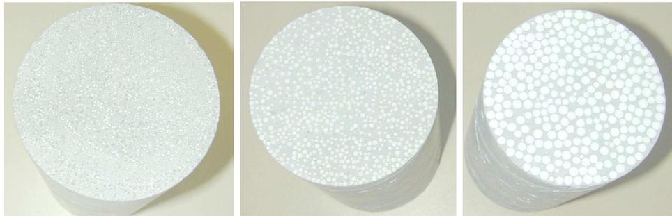
FIG. 3.1: Les trois tailles homothétiques des billes de polystyrène expansé considérées dans cette étude :  $\phi_1 = 1mm$ ,  $\phi_2 = 2.5mm$  et  $\phi_3 = 6.3mm$  : rapport d'homothétie égal à 2.5.
